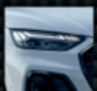
**Matrix LED :** Cette technologie innovante répartit le faisceau lumineux de façon optimale. Ceci permet d'éviter d'éblouir les conducteurs des véhicules qui vous précèdent ou arrivent en sens inverse tout en assurant un éclairage parfait des autres zones périphériques. La répartition de la lumière est garantie par l'activation et la désactivation de segments lumineux individuels. L'éclairage de la route est ainsi nettement amélioré ce qui signifie aussi plus de sécurité et de confort.
